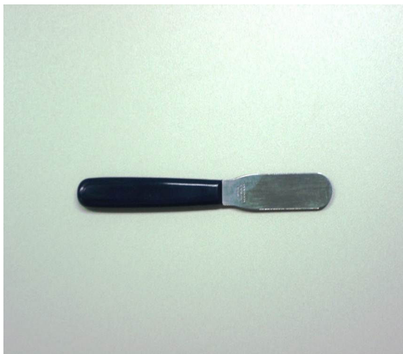
12 - Modelo de espátula (aço inoxidável) para amostragem de óleo.
